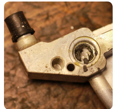
Zichtbare vervuiling bij de condensor-aansluiting
