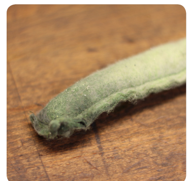
Versleten filter/droger (cartridge) leidt vaak tot inwendige verstopping van de condensor
