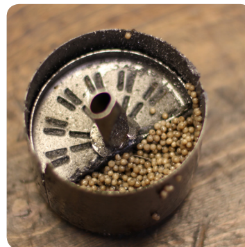
Capa desecante empapada o demasiado aceitosa dentro del secador receptor
