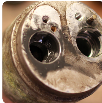
Tal contaminación de las entradas y salidas es equivalente a la obstrucción del secador.
