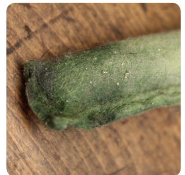
Secador con bolsa desgastada - desecante demasiado empapado con agente UV agregado al sistema
