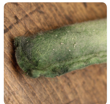
Versleten insert bag droger-droogmiddel te week geworden door een teveel aan UV-dye in het systeem
