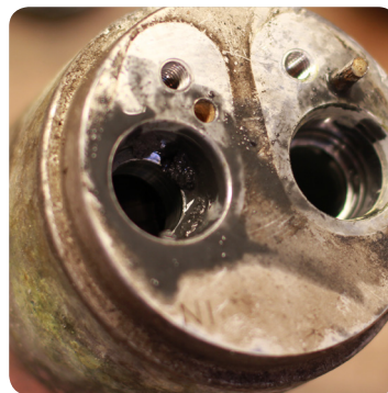
Zulke vervuiling van de in- en uitgang zorgt voor verstopping
