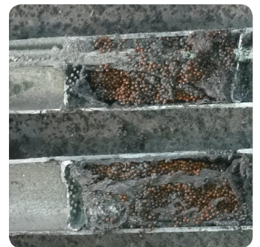
Te vettig en weke filter/droger binnenin de filter/droger
