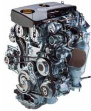
Der Auspuffkrümmer ist in den Zylinderkopf integriert, welcher sich wiederum ganz in der Nähe des Turboladers mit geringer Eigenträgheit befindet. Diese Konfiguration ermöglicht eine schnelle Motorbelastung zur Lieferung von hoher Leistung, wodurch das ab 1.800 U/min verfügbare maximale Drehmoment von 166 Nm fast 30 % über dem Drehmoment eines atmosphärischen 1,6-Liter-Motors bei gleichen Umdrehungen pro Minute liegt. Außerdem wird die Verbrauchseffizienz um 20 % verbessert.
