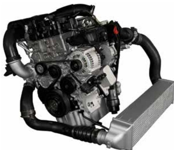
kombiniert werden, um insgesamt 266 kW zu entwickeln. Der Motorblock ist immer aus Aluminium und als Closed-Deck angefertigt, während der Einbau einer Ausgleichswelle zur Reduzierung der Vibrationen dient.
