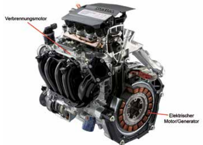
Mechanik eines parallelen Hybridfahrzeuges (Motor von Honda Civic IMA)
