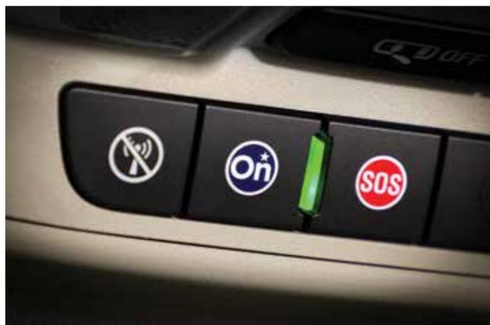
El WiFi con conexión directa a Internet 4G se realiza desde una unidad de mando específica. El sistema dispone de una contraseña de fábrica que es posible cambiar a través de un útil de diagnóstico o llamando al centro de OnStar. El sistema tiene la capacidad de conectar hasta siete dispositivos a la vez. Para realizar la conexión WiFi a un dispositivo, el encendido debe estar conectado y se deben realizar los siguientes pasos:
