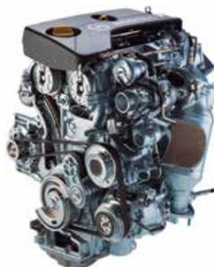
El colector de escape se integra en la culata que, al mismo tiempo, se encuentra muy próxima al turbocompresor de baja inercia; esta configuración posibilita una carga rápida del motor para que entregue una gran potencia, por lo que el par máximo de 166 Nm, disponible desde las 1.800 rpm, es casi un 30 % superior que el del 1,6 litros atmosférico a las mismas revoluciones por minuto, y la eficiencia en el consumo, además, mejora un 20 %.
