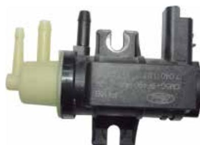
La electroválvula reguladora del turbocompresor se encarga de regular la presión del turbocompresor actuando en el circuito de vacío que alimenta a la válvula neumática. Está controlada, por la unidad de mando, mediante una señal de impulsos modulada variando la frecuencia en función de la carga de motor.
