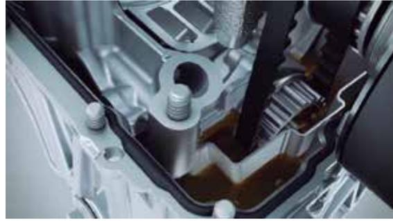
La distribución variable independiente para admisión y escape ayuda a optimizar el flujo de gases a través de la cámara de combustión en todas las velocidades del motor, reduciendo el esfuerzo ejercido por el pistón. Con este sistema, también mejora la suavidad a régimen de ralentí, aumenta el par y la potencia a bajo y alto régimen, se reduce el retraso del turbocompresor y se ahorra combustible.
