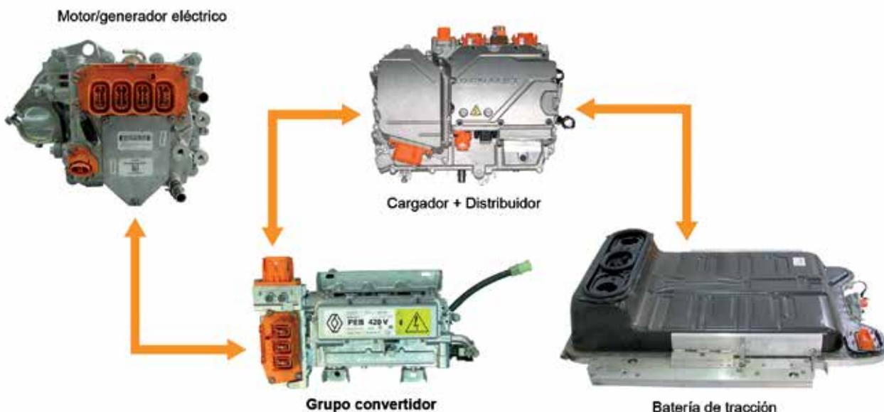
La comunicación entre el grupo convertidor y el motor eléctrico se hace a través de un cableado específico. Todos los cables de alta tensión están apantallados con el fin de evitar al máximo los parásitos.
