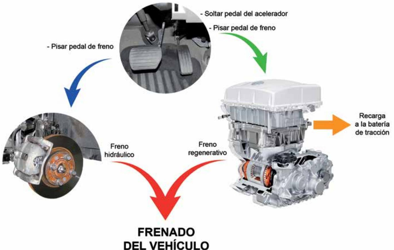
El par resistivo de un generador depende, en parte, del número de revoluciones al que gira. En el paso de motor eléctrico a generador de corriente, existe un breve espacio de tiempo en que no se dispone de ningún tipo de par, momento en el cuál el frenado tiene que ser 100% hidráulico. En cuanto ya se dispone de un par resistivo, el sistema de
