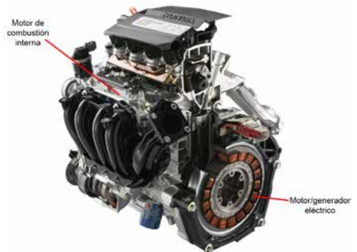
Mecánica de un vehículo híbrido en paralelo (Motor del Honda Civic IMA)
