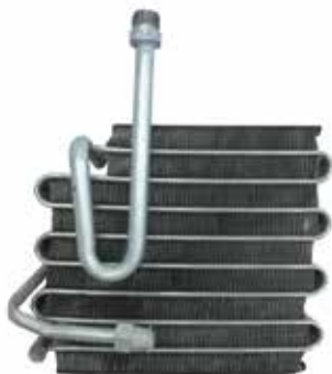
Les évaporateurs à serpentins, composés d'un tube avec une canalisation intérieure multiple.
