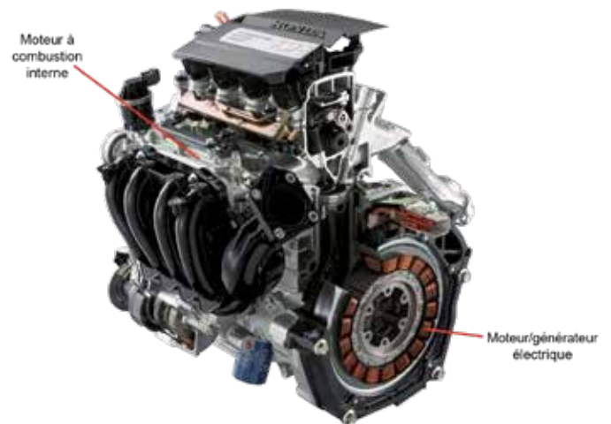
Mécanique d'un véhicule hybride en parallèle (Moteur de Honda Civic IMA)
