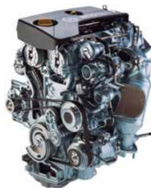
Il collettore di scarico si integra nella culatta che, a sua volta, si trova molto vicina al turbocompressore a bassa inerzia; tale configurazione consente un rapido carico del motore per garantire un'elevata potenza, motivo per cui la coppia massima di 166 Nm, disponibile dai 1.800 giri, è superiore di quasi il 30% rispetto a quella del modello da 1,6 litri atmosferici allo stesso numero di giri al minuto e l'efficienza dei consumi migliora inoltre del 20%.
