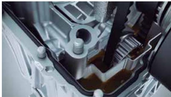
La distribuzione variabile indipendente per aspirazione e scarico consente di ottimizzare il flusso di gas tramite la camera di combustione con qualsiasi velocità del motore, riducendo lo sforzo esercitato dal pistone. Con tale sistema viene migliorata anche la delicatezza a regime minimo, aumentano la coppia motrice e la potenza a regime alto e
