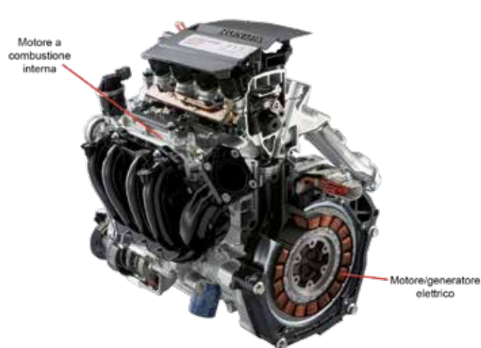
Meccanica di un veicolo ibrido in parallelo (motore della Honda Civic IMA)
