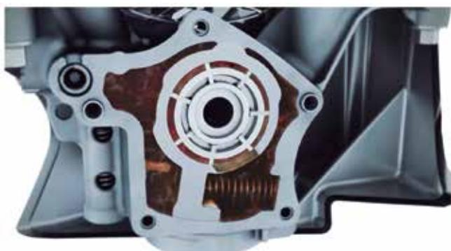
Crpka za ulje s promjenjivim protokom prilagođava količinu protoka potrebama motora u svakom radnom stanju. Ova vrsta crpki smanjuje gubitak mehaničke snage do 10 % smanjujući unutarnje trenje, i tako pridonosi uštedama goriva.
