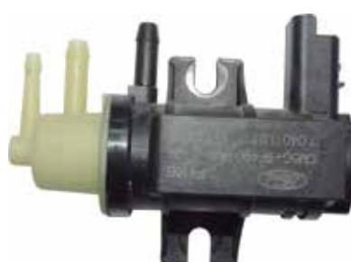
Elektromagnetski ventil za upravljanje turbopunjačem koji regulira tlak turbopunjača djelujući na vakuumski krug koji napaja pneumatski ventil. Njime upravlja upravljačka jedinica putem modulacije impulsnog signala mijenjanjem frekvencije ovisno o opterećenju motora.
