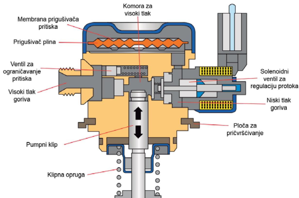
Elektromagnet radi zajedno sa senzorom tlaka goriva u zatvorenoj upravljačkoj petlji u programiranju upravljačke jedinice. Aktiviranjem elektromagnetskog ventila potreban tlak goriva dovodi se u šipku za
