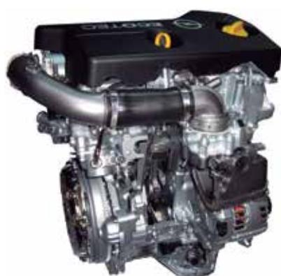
Ispušni razdjelnik je integriran u glavu cilindra, koja se nalazi vrlo blizu turbopunjača s niskom inercijom. Ovakva konfiguracija omogućuje brzo punjenje motora za pružanje velike snage, pa je zato najveći okretni moment od 166 Nm, dostupan od 1800 o/min, gotovo 30 % veći nego u 1,6-litarskom motoru s prirodnom aspiracijom pri istim okretajima, a učinkovitost sagorijevanja je također 20 % veća.
