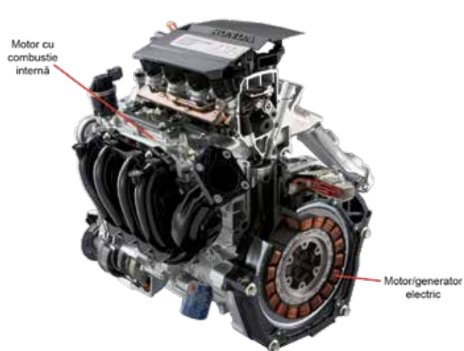
Mecanica unui vehicul hibrid în paralel (Motor de Honda Civic IMA)
