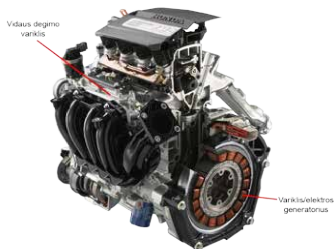
Hibridinės transporto priemonės su lygiagrečiąja pavara mechaninė dalis (Honda Civic IMA variklis)
