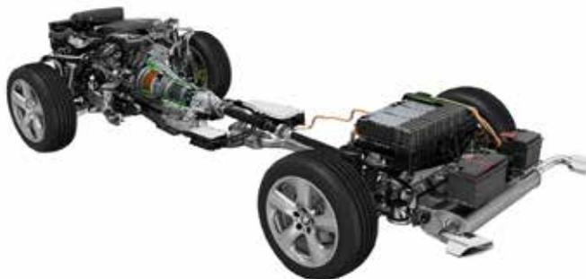
Основная идея - это объединение ДВС и электродвигателя в единую систему. Назначением ДВС является передача мощности на систему тяги для ускорения, когда автомобиль находится в движении. Электродвигатель же отвечает за дополнительный крутящий момент двигателя, и его назначением является разгон автомобиля от момента начала движения.
