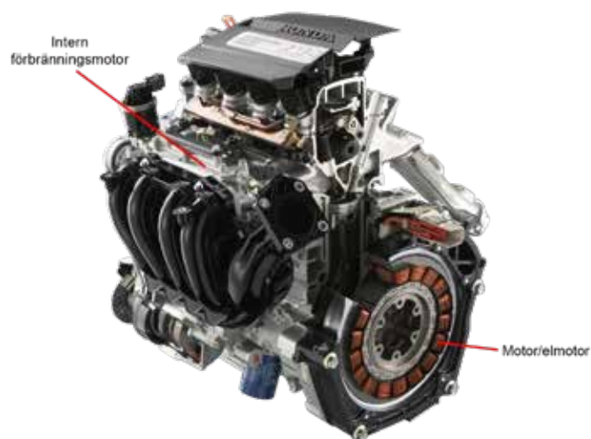
Mekanik i ett hybridfordon med parallell kombination (Motorn i Honda Civic IMA)
