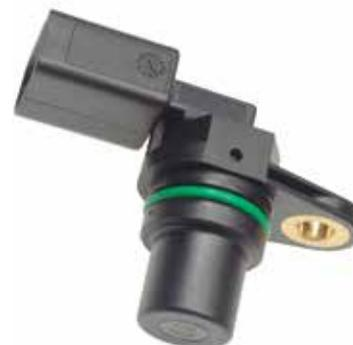
**Kurbelwellensensor.** Ebenfalls ein Hall-Sensor, der die Drehzahl und Winkellage der Motorkurbelwelle misst, um das Zylinderabschaltsystem zu aktivieren und sowohl den Zündzeitpunkt als auch den Einspritzzeitpunkt zu steuern.
