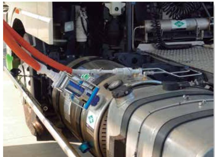
Es gibt Umrüstsätze auf dem Markt, mit denen das Gassystem an den Dieselmotor angepasst werden kann, und sogar Dieselmotoren, die in Ländern, in denen nationale Vorschriften eine Umrüstung zulassen, bereits für eine vollständige Umrüstung ausgeliefert werden. Viele der Schwerfahrzeugehersteller vermarkten Dieselmodelle, die werkseitig bereits mit Dual-Fuel-Motoren ausgestattet sind, vor allem Nutz-, Bau- und Bergbaufahrzeuge.
