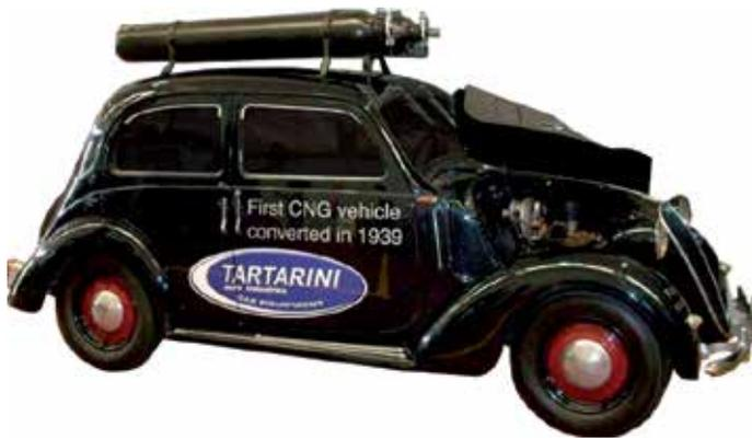
in komprimiertem Zustand wurde der übergroße Beutel durch eine vergleichsweise kleine Gasflasche ersetzt, die, wenn sie einmal leer war, leicht durch eine andere ersetzt werden konnte.
