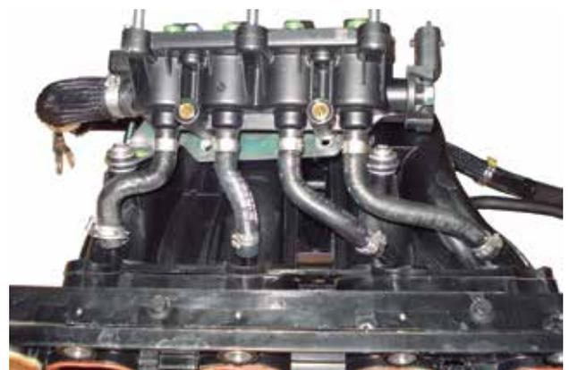
Das gesamte System wird durch ein spezifisches Steuergerät kontrolliert, das mit dem Motorsteuergerät kommuniziert, um den Kraftstoffwechsel korrekt durchzuführen und die notwendigen Informationen für die Dosierung der Gasmenge zu erhalten. An einer beliebigen Stelle des Kreislaufs zwischen dem Tankauslass und dem Eingang zum Kraftstoffverteiler kann ein für die Beseitigung der LPG-Verunreinigungen vorgesehener Filter eingebaut werden. Zudem befindet sich normalerweise ein Drucksensor
