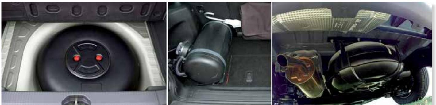
Der Kraftstoff in flüssigem Zustand wird vom LPG-Tank durch Leitungen zum Druckregler geleitet, wo sich ein weiteres Magnetventil befindet. Der Druckregler hat die Funktion, den LPG-Druck auf ca. 1 bar zu reduzieren, um so den Zustandswechsel von flüssig auf gasförmig zu ermöglichen und die Dosierung zum Zeitpunkt der Einspritzung zu erleichtern.
