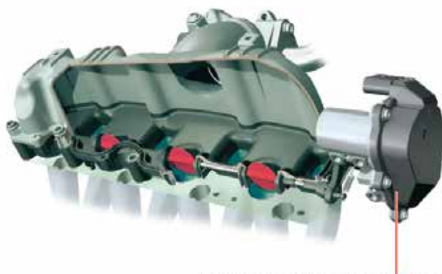
Actuador de control de turbulencia
