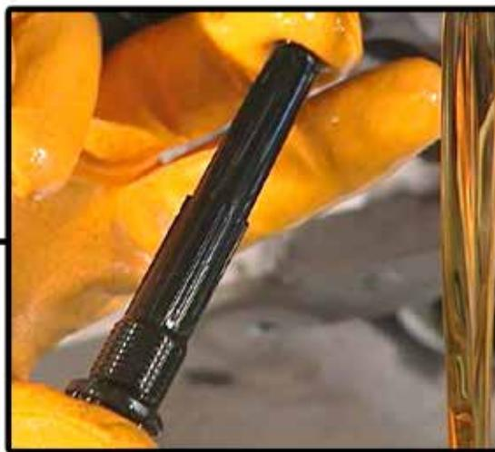
Une fois l'huile extraite et le filtre remplacé, il faut réassembler la canule de niveau, puis visser l'outil de remplissage d'huile et verser **5,5 litres** d'huile. Après le remplissage, retirez l'outil, récupérez toute huile susceptible de déborder et, lorsqu'elle ne coule plus, montez la vis à la main.
