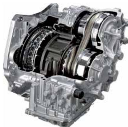
Le contrôle de l'ouverture ou de la fermeture des plaques modifie le diamètre intérieur effectif et produit différents rapports de transmission. La transmission de la force entre les deux poulies s'effectue à l'aide d'une courroie, de sorte que, en changeant le diamètre des poulies, le rapport de transmission varie progressivement, soit en démultipliant, soit en multipliant le couple de sortie du moteur.
