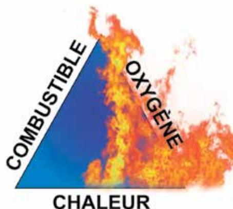
dire, lorsqu'il a totalement brûlé. Cependant, en réalité, à cause des caractéristiques inhérentes à la nature de la combustion et du fait que, pendant la combustion, il existe une variation continue de la proportion du mélange entre l'air et le combustible, **la combustion idéale ne se fait pas en pratique.**
