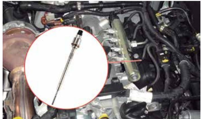
type piézorésistif détecte la valeur de la pression dans la chambre de combustion en temps réel par la déformation d'une membrane de mesure qui reçoit le mouvement de la barre mentionnée.
