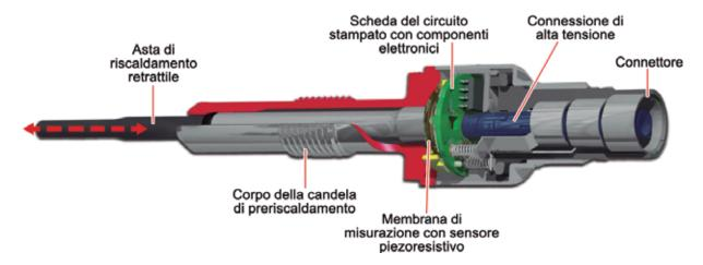
Le informazioni ottenute tramite questo sensore vengono filtrate e trasmesse all'unità di controllo del motore affinché quest'ultima adatti la portata e l'evoluzione dell'iniezione in tutta la fascia di giri del motore. In tal modo si ottimizza il processo di combustione per evitare la formazione di particelle e di ossidi di azoto nei gas di scarico, e si amplia quindi il periodo di rigenerazione del filtro di particelle.
