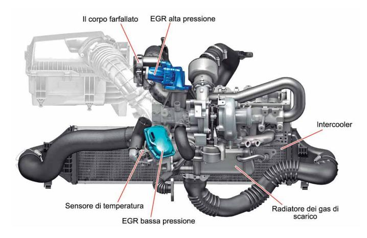
L'unità di controllo del motore stabilisce se combinare la modalità di ricircolo dei gas di scarico in base ai segnali ricevuti dal regime del motore, la richiesta di coppia, la temperatura e la pressione dei gas di scarico nel modulo di depurazione e le informazioni delle sonde lambda. In tal modo si riesce a ridurre l'ossigeno in eccesso della combustione e a ridurre la temperatura delle camere di combustione
